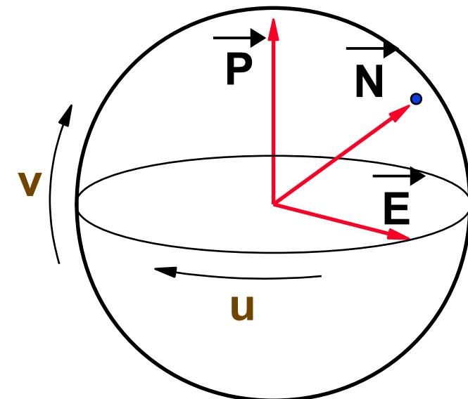
$$\Phi = \arccos(-\vec{N} \cdot \vec{P}), \quad \theta = \frac{\arccos[(\vec{N} \cdot \vec{E}) / \sin \Phi]}{2\pi}$$
