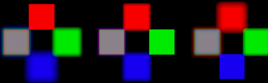
Obrázek C.1: scene01.xml Zobrazení spojnou čočkou, obrazové roviny R, G, B (viz odst. 7.1.1)
